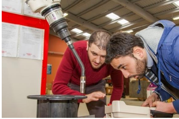
Şekil 1. Robotlu kaynak eğitimi uygulama safhasında operatörlerin el terminali ile kaynak yörüngesini tespiti
