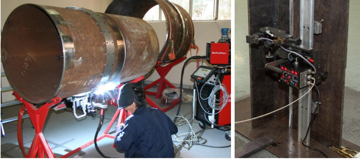
Şekil 3. Orbital alın kaynağı ve mekanize köşe kaynağı uygulamaları
